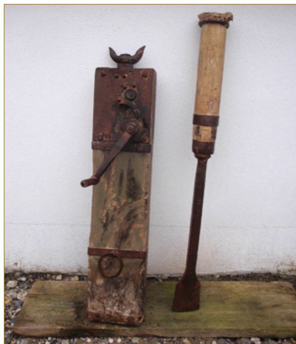
Zwei wichtige Werkzeuge zum Wurzelstöcke entfernen. Links die sogenannte Stockwinde aus dem Jahre 1922, eine Zahnstangenwinde und daneben ein Stockstemmeisen mit einer Länge von 1,3 m. Foto: Johann Hötzinger, Reichenrott
