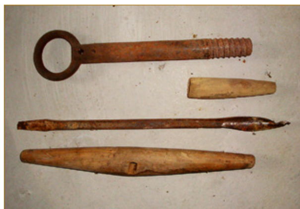
Wurzelstocksprengen: Links befindet sich ein Holzbohrer und rechts davon die sogenannte „Stockbix“ Foto: Johann Hötzinger, Reichenrott
