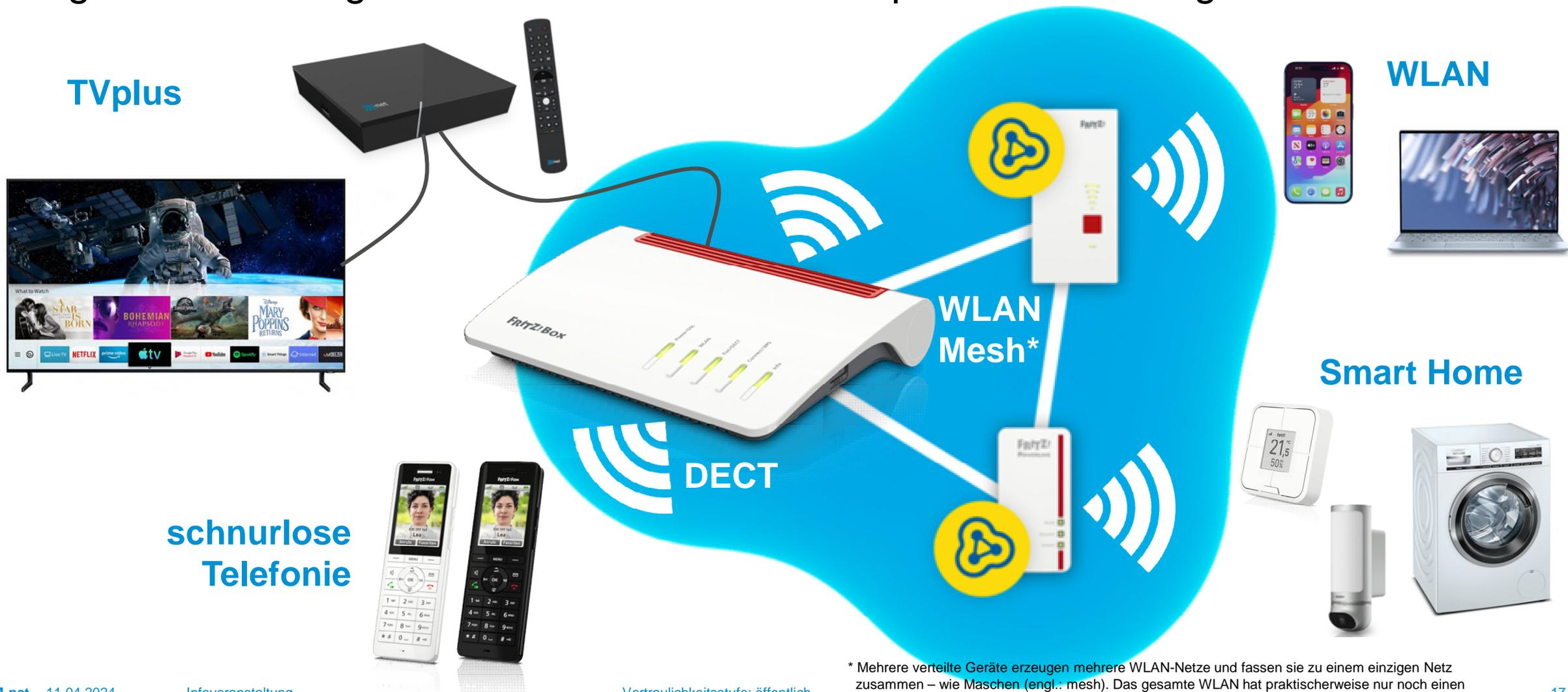
\* Mehrere verteilte Geräte erzeugen mehrere WLAN-Netze und fassen sie zu einem einzigen Netz zusammen – wie Maschen (engl.: mesh). Das gesamte WLAN hat praktisch nur noch einen Namen und ein Passwort.
